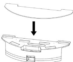
3) Introduce el depósito de agua y seleccione el modo de limpieza que necesite.
